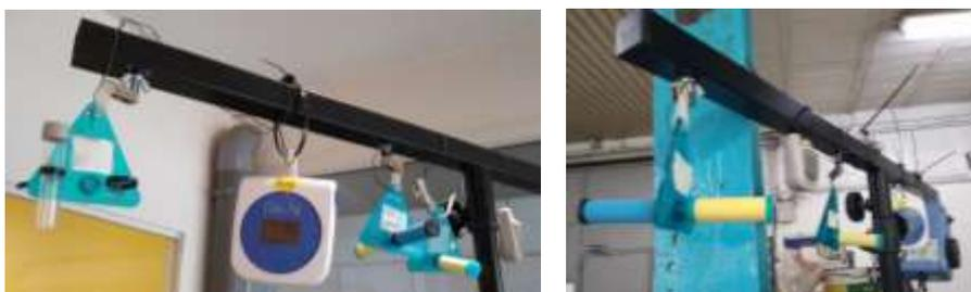
Figure 2-6 Dispositif de mesure de qualité de l'air installé dans l'aire d'accueil/bureau à gauche et l'atelier à droite.
