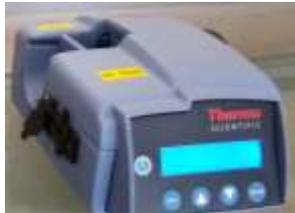
Figure 2-9 Boîtier pour la mesure des PM2,5
